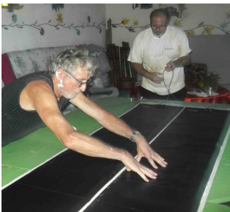
Collage laborieux des plaques photovoltaïques souples sur une feuille de tôle laquée
